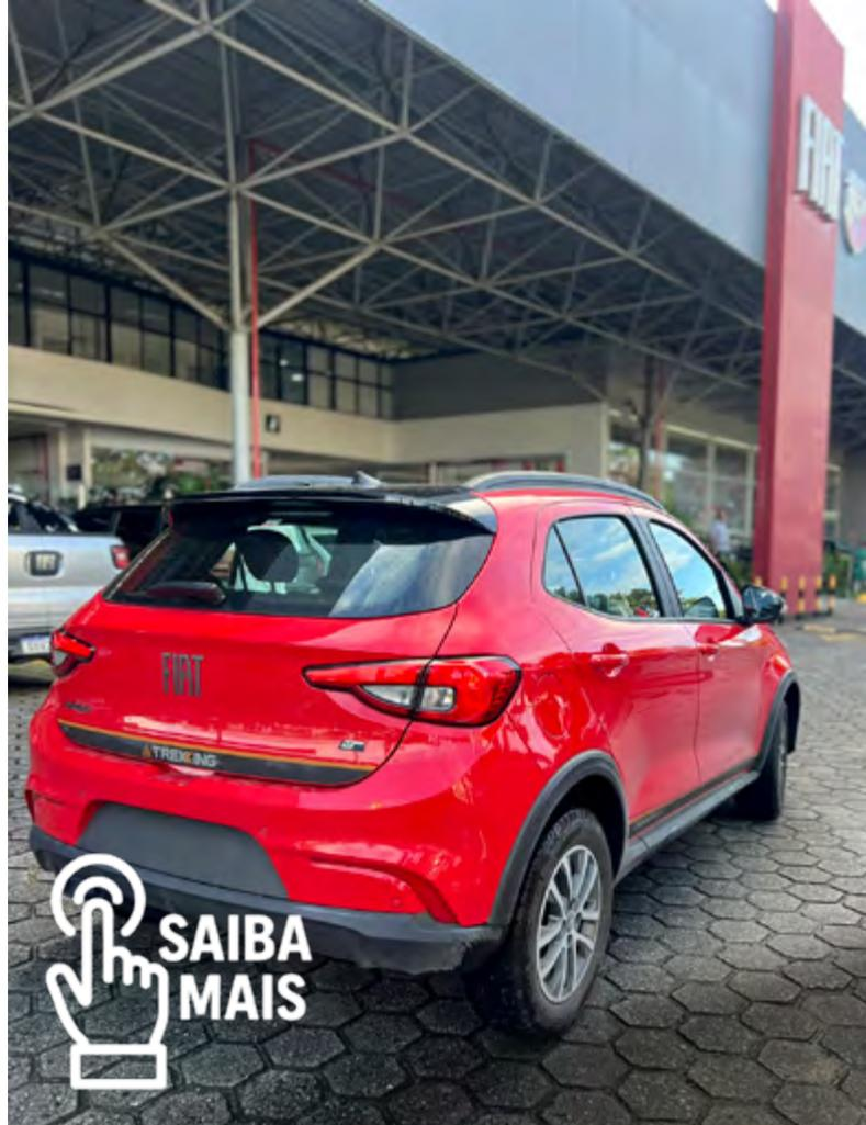
A mecânica segue sem alterações, e isso é um mérito. O motor 1.3 Firefly flex, aspirado, entrega até 107 cv com etanol e 13,7 kgfm de torque, trabalhando em conjunto com o câmbio CVT que simula sete marchas. É um conjunto confiável e de manutenção simples, que privilegia suavidade e eficiência. De acordo com o Inmetro, o consumo pode chegar a 14,3 km/l com gasolina na estrada e 12,8 km/l na cidade, números competitivos para o segmento.
